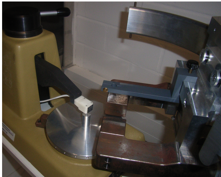
Abb. 5.1: Foto des GMR-Messplatzes. Enthalten sind die Messapparatur der Firma Signatone mit dem ursprünglichen GMR-Messkopf und der Magnet, der über den Substrathalter verschoben werden kann. Die Halterung oberhalb des Magneten dient als Führung für die Hallsonde.
