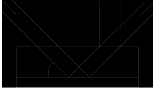
ABB. 4.2: Darstellung der Berechnung des Wechselwirkungsbereichs von Probe und Synchrotronstrahl aus Gl. (4.1). Dabei ist d die Schichtsystemdicke, s die Strahlbreite und \theta der Einfallswinkel
