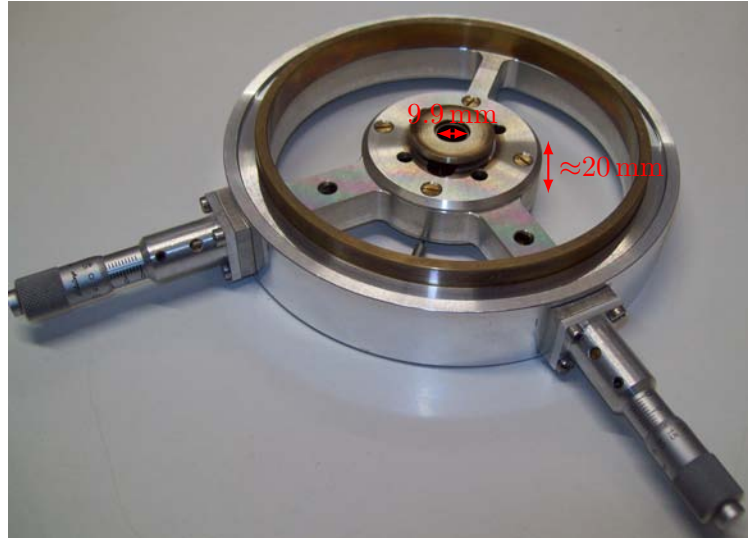
ABB. 4.11: Bauteil in der alten ISA, das den Strahlengang für die Messung des Strahlprofils beim Herunterregeln der Linsenspannung stört
