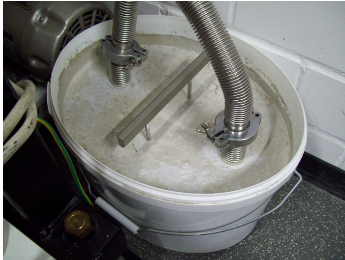
Abbildung 3.23: Ein in Estrich -Beton eingegossener Wellschlauch zur Reduzierung des Schwingungsübertrags von der Vorpumpe zum Rezipienten.
