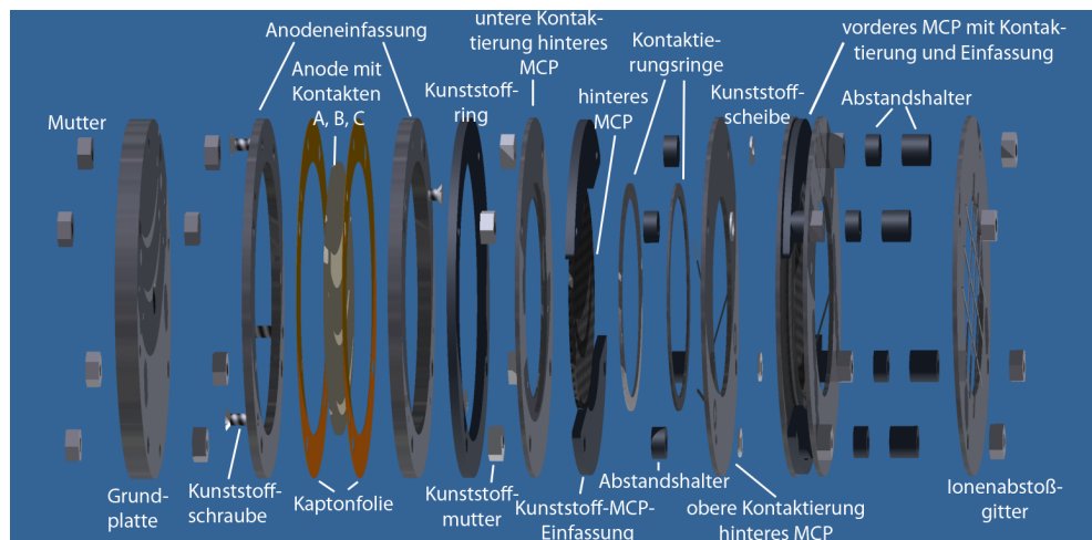
Abb. 3.3: Eine detaillierte und beschriftete seitliche Explosionsdarstellung des Detektors [Han13].
