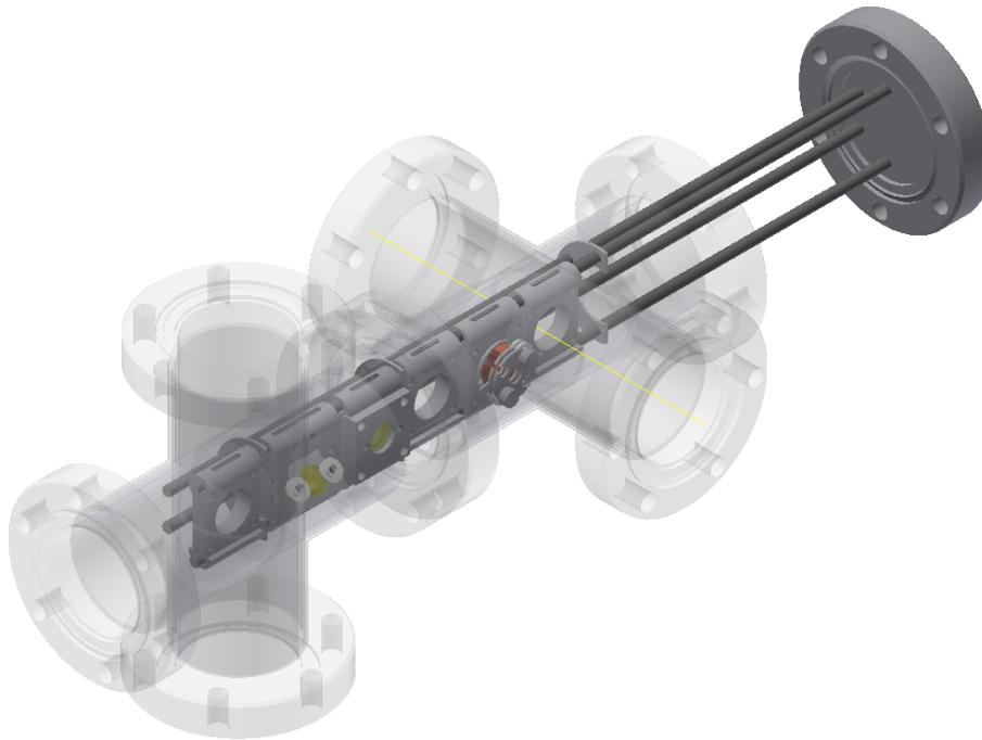
Abb. 4.2: Eine Darstellung des gesamten Aufbau des MADLoQs zusammen mit zwei CF-40 Kreuzen.
