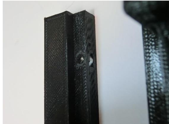
Abbildung 5: Einpassung der Mutter in den Rahmen
