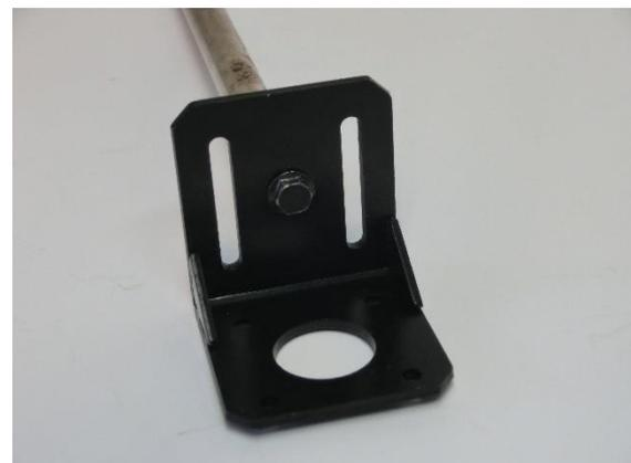
Abbildung 1: Befestigung einer Stativstange an der Motorhalterung.
