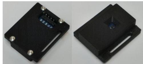
Abbildung 6: Sensor GY30-BH1750 in der Sensorhalterung
