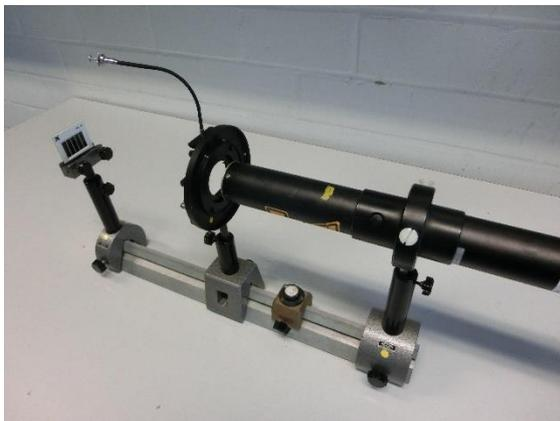
Abbildung 7: Aufbau Laser & Beugungsobjekt
