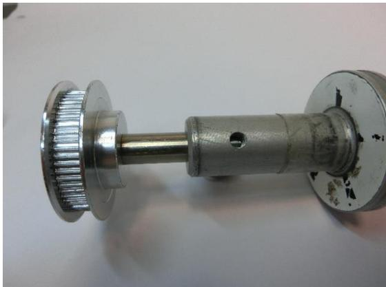
Abbildung 3: Befestigung des Zahnrads (5 mm Bohrung) an dem Drehlager mittels einer Stativstange (10 mm Durchmesser).
