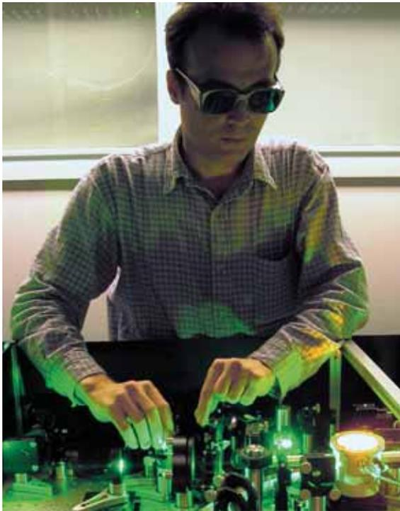
Ein Doktorand beim Justieren einer Laseranlage mit einer Lichtleistung von 40 Gigawatt pro Lichtpuls
