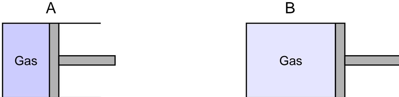
Langsames isothermes expandieren ist reversibel. Die vom Gas geleistete mechanische Arbeit wird als Wärmemenge dem Gas wieder zugeführt.
