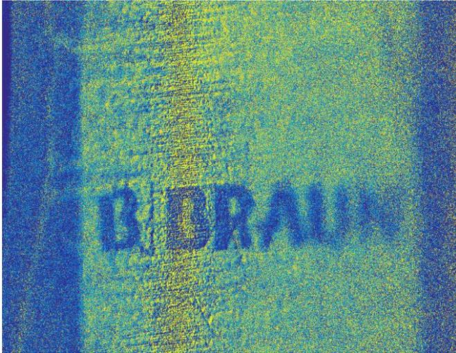
Abb. 5.21: Ortsaufgelöstes Abbild der Magnetisierungsrichtung eines strukturierten Schichtsystems auf Aluminiumsubstrat.<sup>[Müg15]</sup>
