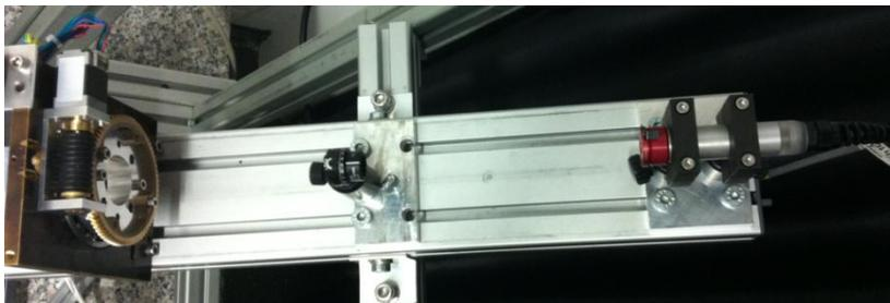
Abb. 4.2: Laserarm mit Laser, vorläufigen Polarisator und Polarisatorhalterung.
