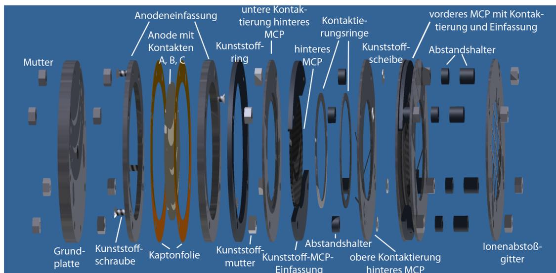
**Abb. 3.6:** Detaillierter Aufbau des Detektors. Vier elektrisch isolierende Kunststoff-Gewindestangen werden an der Grundplatte montiert (links im Bild). Nacheinander werden die einzelnen Komponenten aufgesetzt. Im betriebsfertigen Zustand ist der Detektor einige Zentimeter lang. Der Durchmesser beträgt 79 mm.
