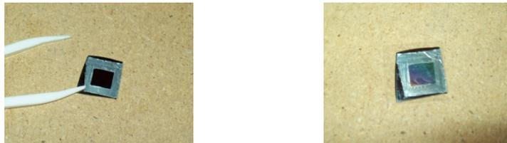
**Abbildung 4.5:** Substrat mit Parafilm (links) und mit Partikellösung befüllte Flüssigkeitszelle (rechts).
