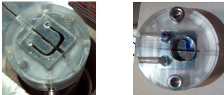
**Abbildung 4.8:** Mischzelle mit Trenndraht unbefüllt (links) und befüllt mit Titangelb und Coomassie Brillant Blau G250 (rechts).
