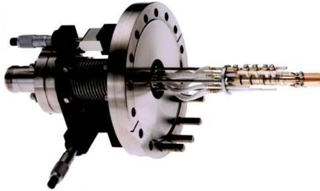
Abbildung 11: Innenleben der in einem CF-100 Flansch montierten e-Gun. Aus [OMb].
