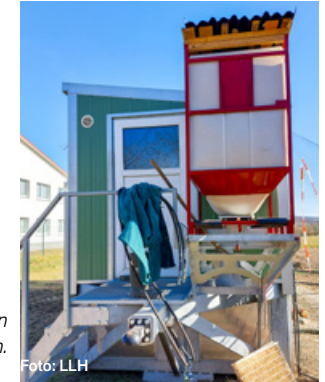
Das auf dem Silo angebrachte Dach kann den Feuchtigkeitseintrag verringern.
