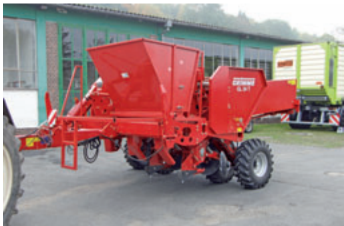
Abb. 5: Legemaschine mit aufgebauter Dosiereinheit (2-reihig)
