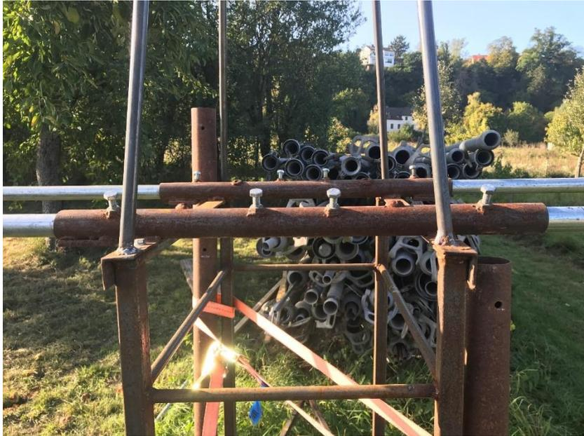
Abbildung 6: Verbindung Fahrgestell mit Ausleger
