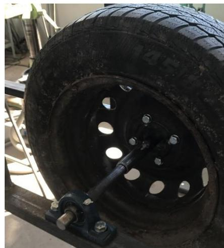
Abbildung 2: Kraftübertragung Achse/Reifen
