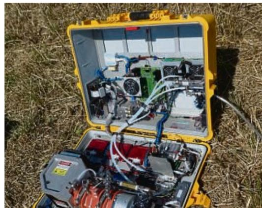
**Ein Koffer voller Hightech:** Bodenluftproben werden mittels Laser auf Inhaltsstoffe untersucht.
