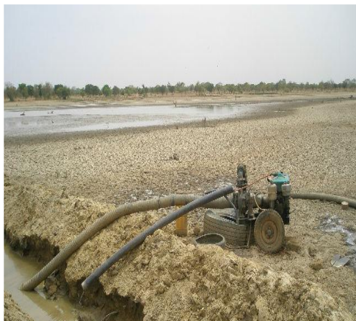
Figure 7 : Irrigation par Pompage depuis les rigoles reliées aux barrages, Mars 2008
