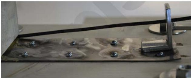
Abb.1: Stahlblech-Holz-Verbindung mit Schrauben als Verbindungsmittel nach zyklischer Belastung[1]
