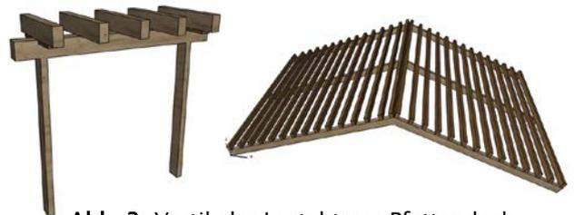
Abb. 3: Vertikaler Lastabtrag; Pfettendach
