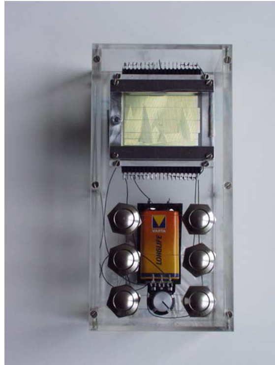
Bildunterschrift 1: Demonstrationsbox mit Test-Schaltknöpfen und eingebautem 3D P-OLED Display.
