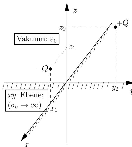
Abbildung 4.1: Elektrostatische Punktladungsverteilung über einer ideal elektrisch leitenden Ebene
