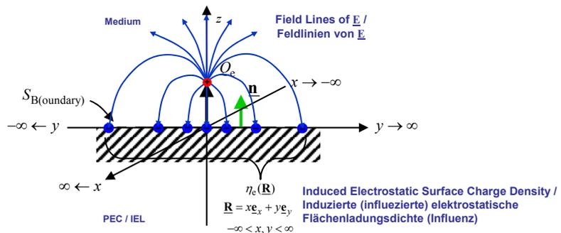
Without the Method of Images we have to solve the following Integral Equation for the Unknown Induced Electrostatic Surface Charge / Ohne die Spiegelungsmethode muss man die folgende Integralgleichung für die induzierte (influzierte) elektrostatische Flächenladungsdichte lösen
