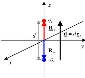
Electrostatic Dipole Moment / Elektrische Dipolmoment
