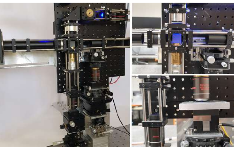
Abbildung 2: hochauflösendes Linnik-Interferenzmikroskop (Eigenbau)
