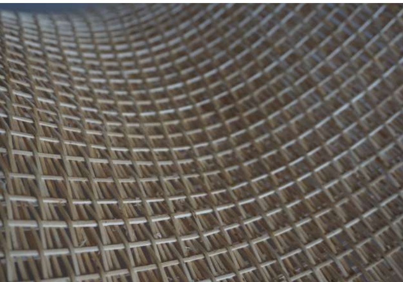
Abbildung 1: Textile Tektonik im Holzbau: Gewebe aus Massivholzmonofil © BAU KUNST ERFINDEN
