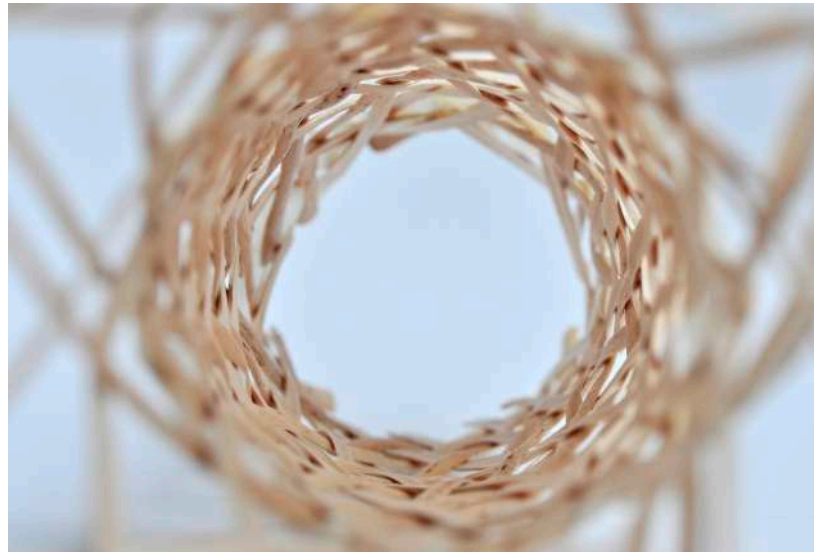
Abbildung 2: TERA X – Geflochtenes Holz: Technisches Radialflechten von Massivholzstrukturen © BAU KUNST ERFINDEN
