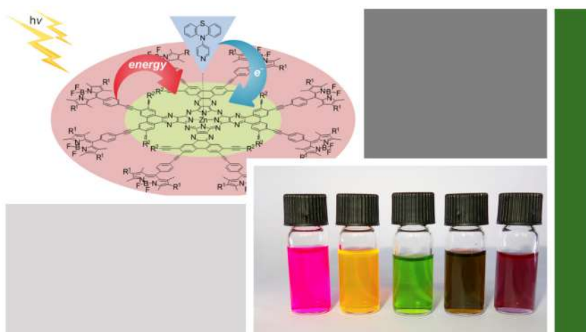
Abbildung 1: Funktionsfarbstoff, der nach Lichtanregung sowohl Energie- als auch Elektronentransferprozesse zeigt (links) zusammen mit Farbeindruck der Einzelkomponenten in Lösung (rechts).
