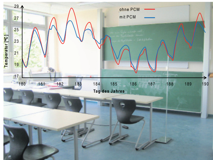
Einfluss des PCM auf die Raumtemperatur.
