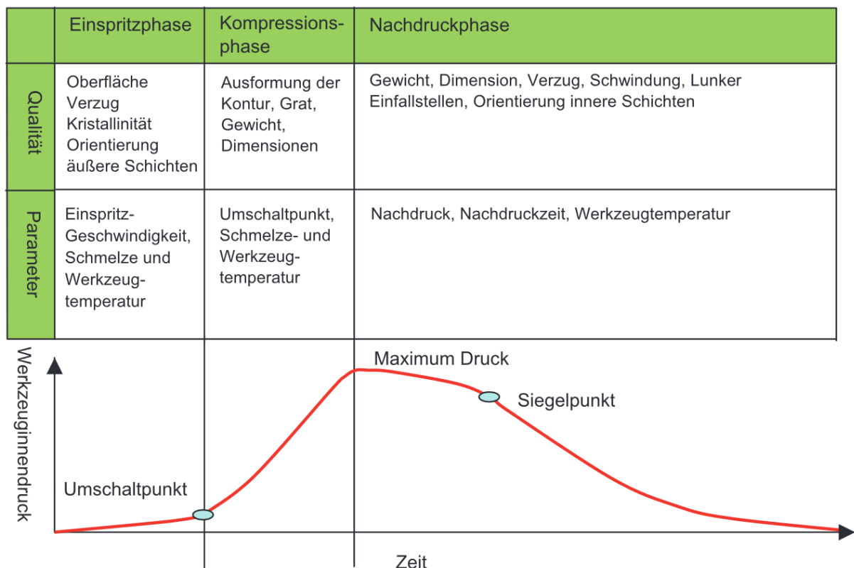
Abbildung 1: Qualitativer Verlauf des Werkzeuginnendrucks, korrelierende Formteileigenschaften und Einflussparameter [3]
