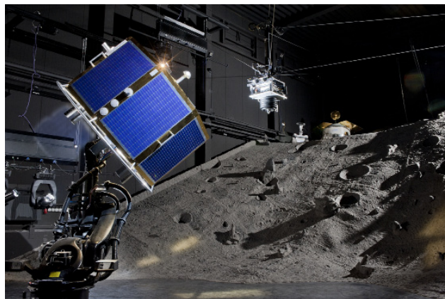
Künstliche Kraterlandschaft als Testumgebung für Roboter, Quelle: DFKI GmbH
