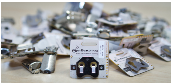
MyGroup basiert auf der Lokalisierung der Nutzer in Gebäuden mittels aktiver RFID-Tags
