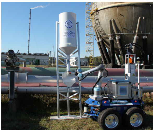
Abb. 2: Telemanipulationsroboter bedient in der PCK-Raffinerie das Ventil des Mock-Ups einer Entwässerung.
