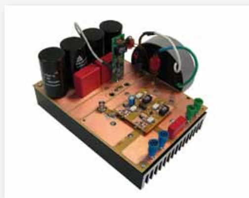
Versuchsaufbau 1kW-Wechselrichter mit SiC-JFET Laboratory prototype of 1kW inverter with SiC-JFET
