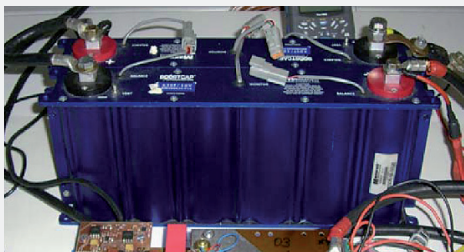
Leistungselektronischer Wandler für Supercaps
