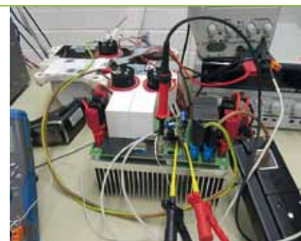
Laboraufbau eines Hochsetzstellers Experimental setup of a step-up converter
