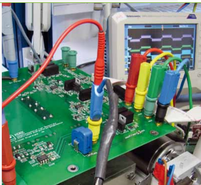
Laboraufbau Antriebswechselrichter Experimental setup drive-inverter
