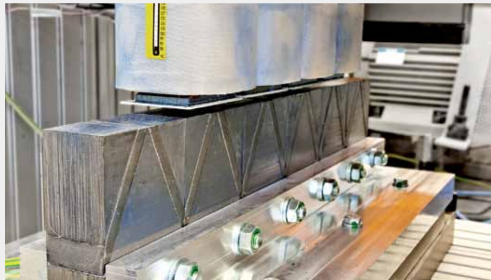
Ausschnitt des Ringgenerators in den entwickelten Versuchsmodellen Ring generator segment in the test bench
