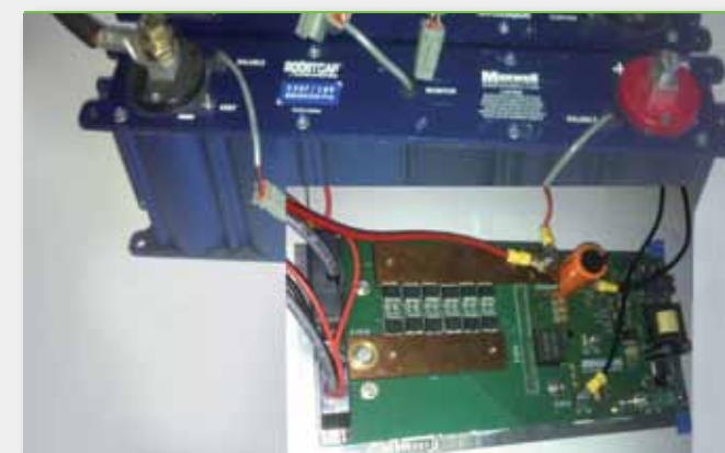
Abb. 1: Doppelschicht-Kondensator-Pack 2x330F/16V/1mΩ (Maxwell) mit peripherer Leistungselektronik zur Eingliederung in Systeme (Uni Kassel) Fig. 1: Double layer capacitor stack 2x330F/16V/1mΩ (Maxwell) with peripheral power electronics for system integration (University Kassel)
