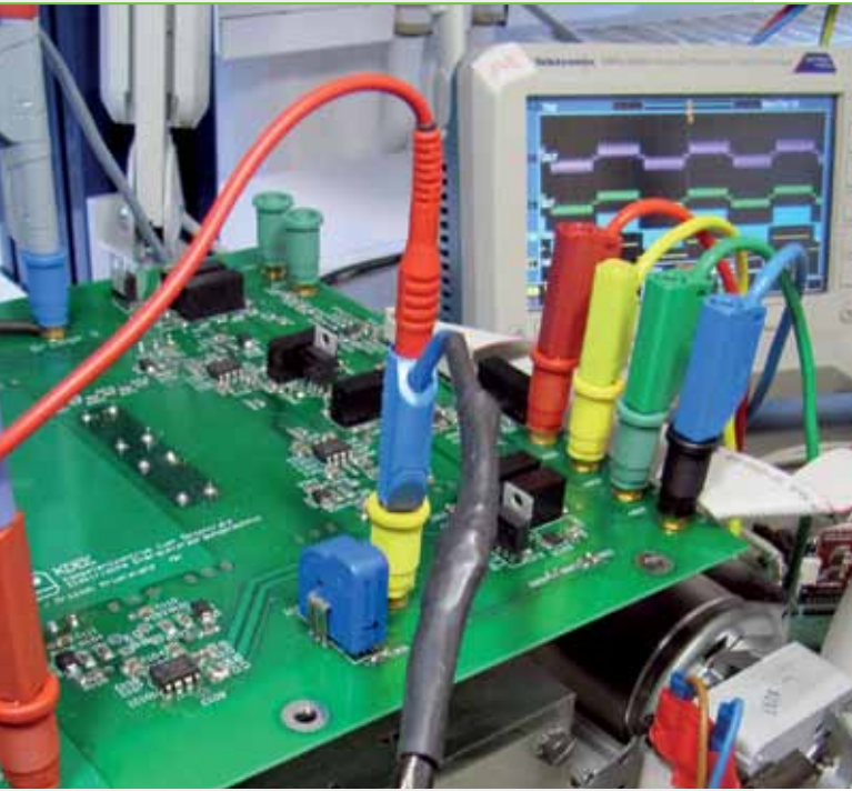
Laboraufbau Antriebswechselrichter Experimental setup drive-inverter
