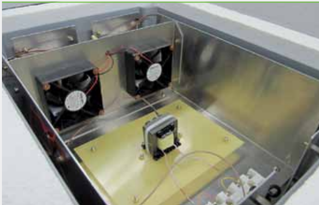
Kalorimeter mit Prüfling (links), Prüfstand für Wickelgüter (rechts)
