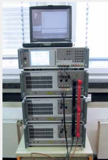
Hochbandbreitiger Impedanzanalysator High Bandwidth impedance analyser
