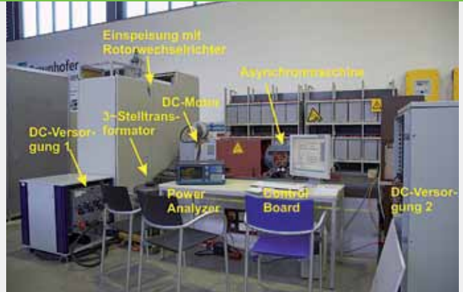
Der 10kVA-Versuchsstand Experimental 10kVA-setup
