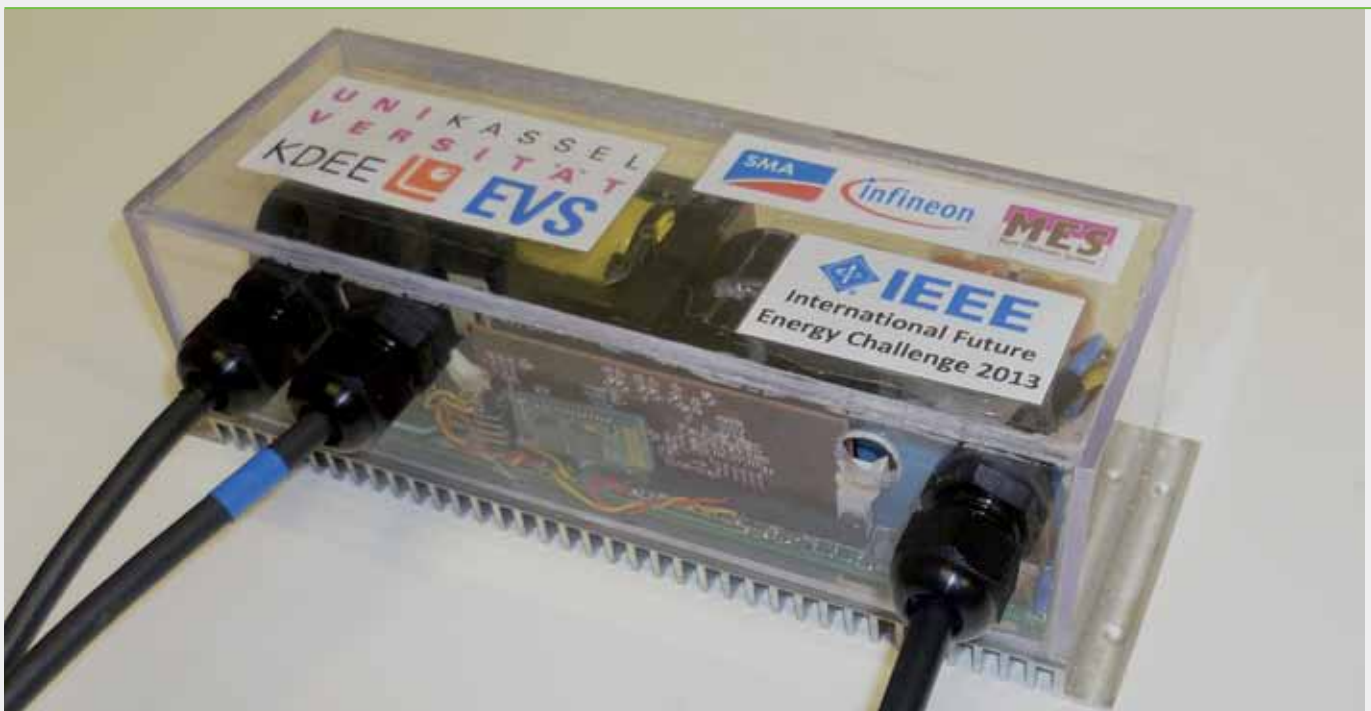
Prototyp des kompakten Kleinstwechselrichters. | Prototype of the compact micro-inverter.
