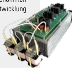
a) Optimierungsergebnisse und (b) Demonstrator der Wechselrichterstufe a) Optimization Results and (b) Demonstrator of the Inverter Stage
