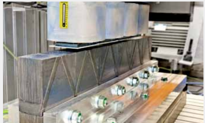
Ausschnitt des Ringgenerators in den entwickelten Versuchsmodellen Ring generator segment in the test bench
