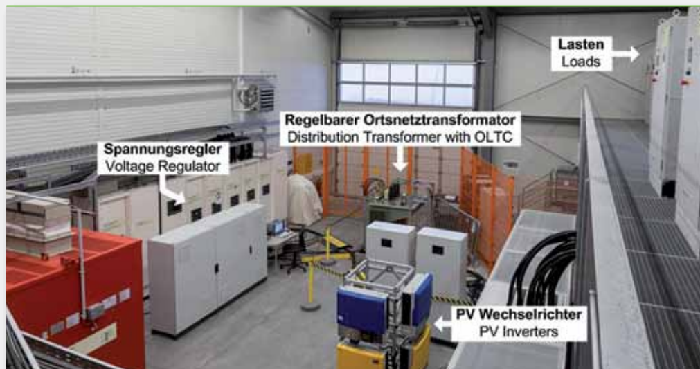
Spannungsregler im Testzentrum SysTec des Fraunhofer IWES. Voltage regulator in the test centre SysTec of Fraunhofer IWES.
