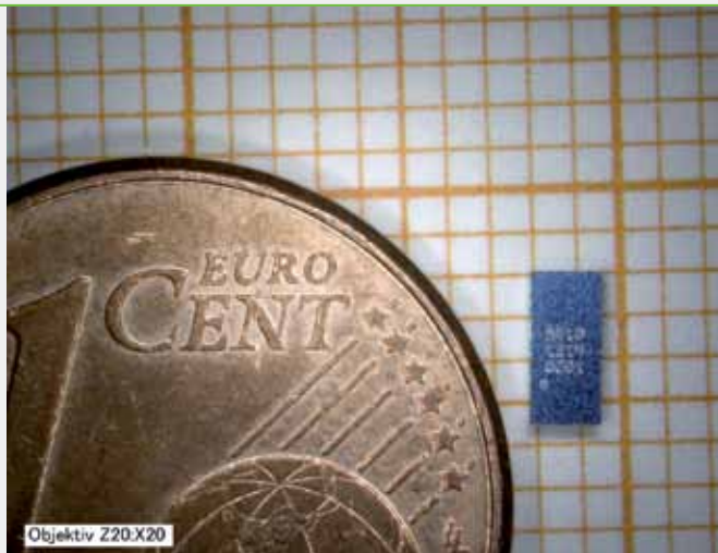
Der Größenvergleich von einem eGaN-FET mit einer Eineurocent-Münze. Size comparison of an eGaN FET with a One Eurocent coin.
