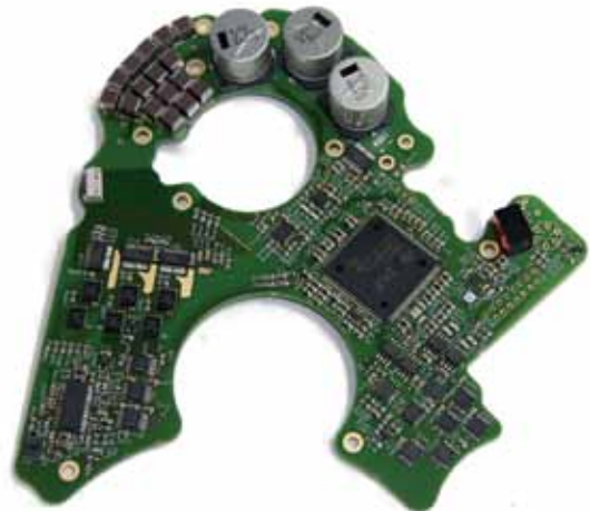
Prototyp der Leiterplatte zur Integration in dem Pedelec
