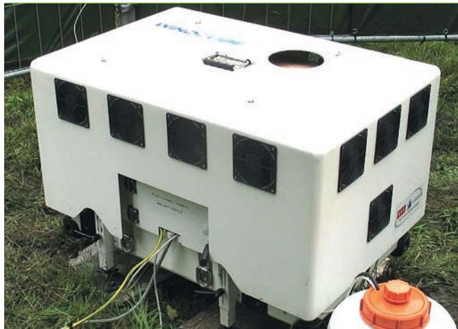
LiDAR-Gerät des Typs Windcube, wie es auch in der Messkampagne innerhalb des LiMeS-Projektes zum Einsatz kam (Foto bereitgestellt durch Projektpartner Fraunhofer IEE).
