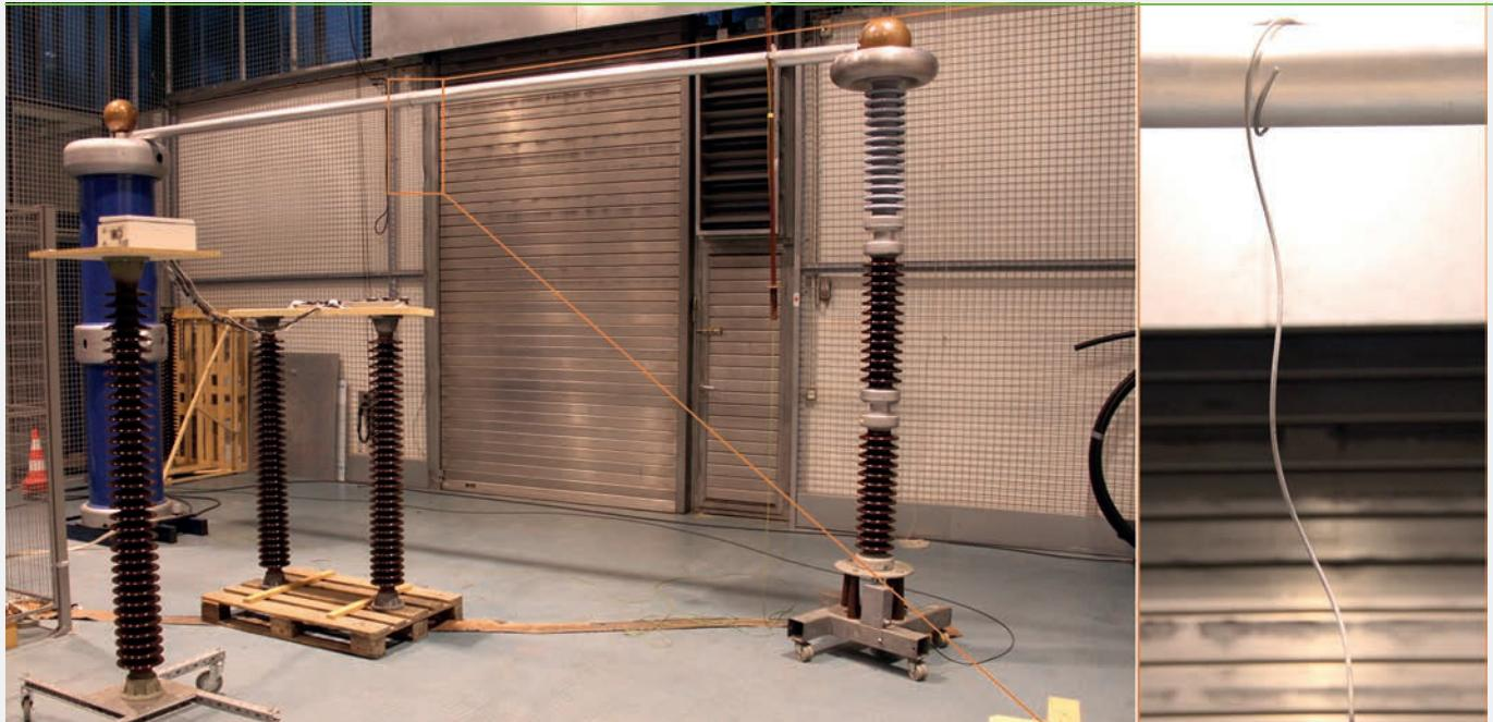
Korona-Versuchsstand mit gerissenem Freileitungs-Draht
