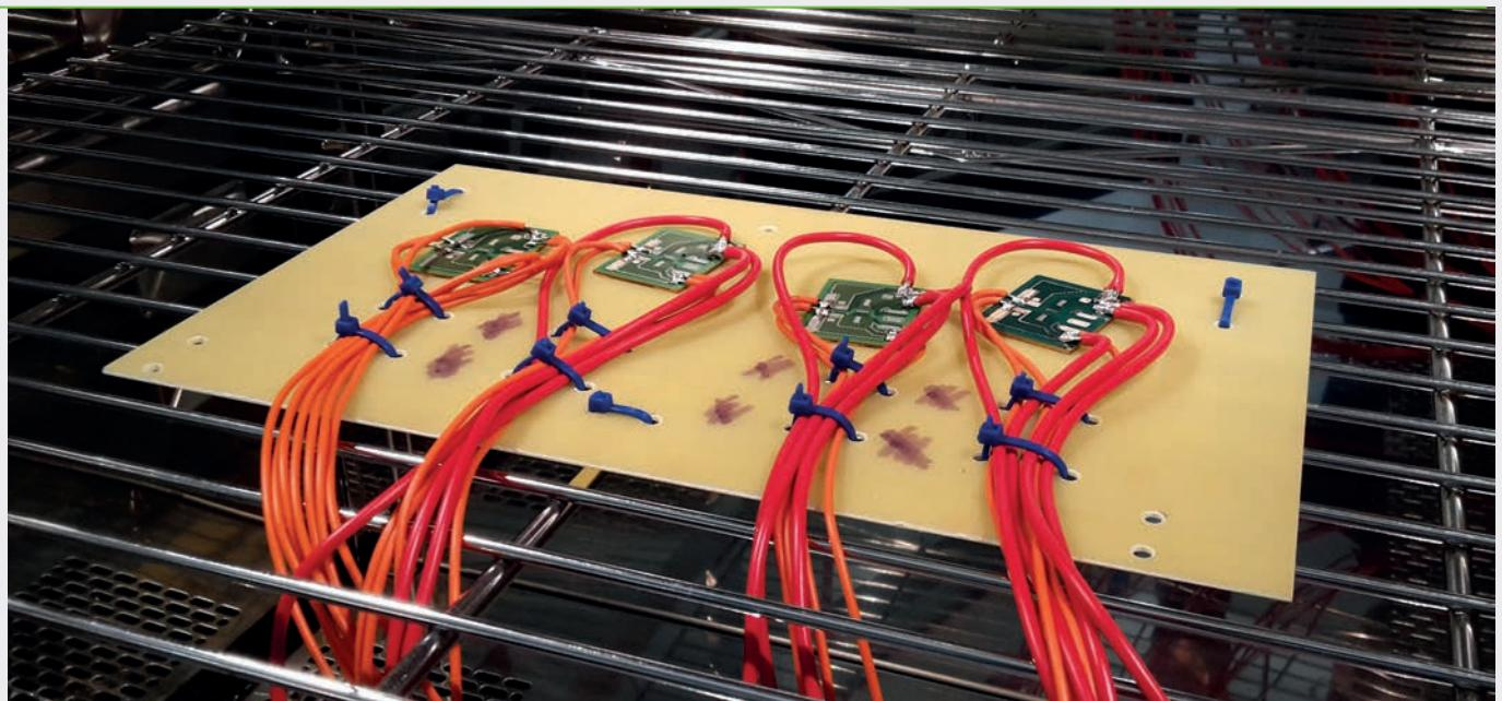
Module mit eingebetteten SiC JFETs im Klimaschrank zur Durchführung von H3TRB Test
