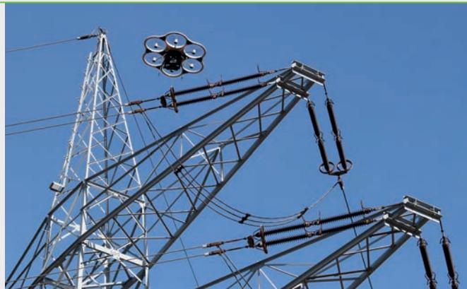
Multikopter beim Flug an einer Freileitung
