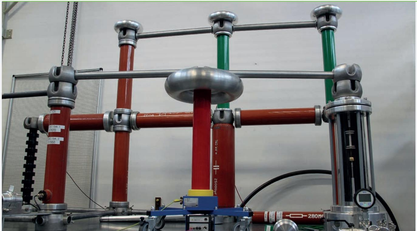
Versuchsaufbau zur Messung des Teilentladungs-Verhaltens von Pressmassen.
