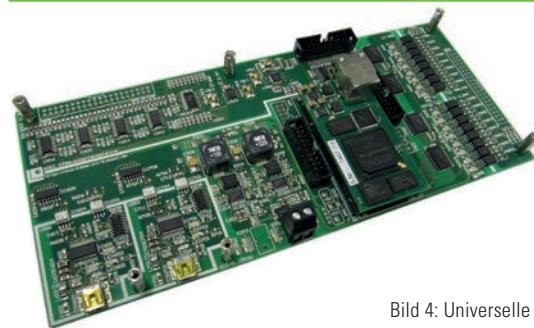
Bild 4: Universelle FPGA-Platine mit Multi-Kanal ADC und PWM
