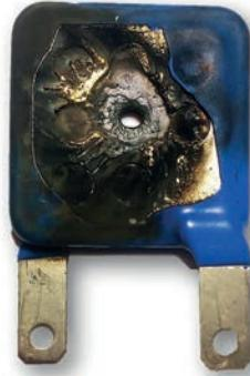
Untersuchung des Ausfallverhalten eines Metallocid-Varistors durch gezielte praxisrelevante Belastungen
