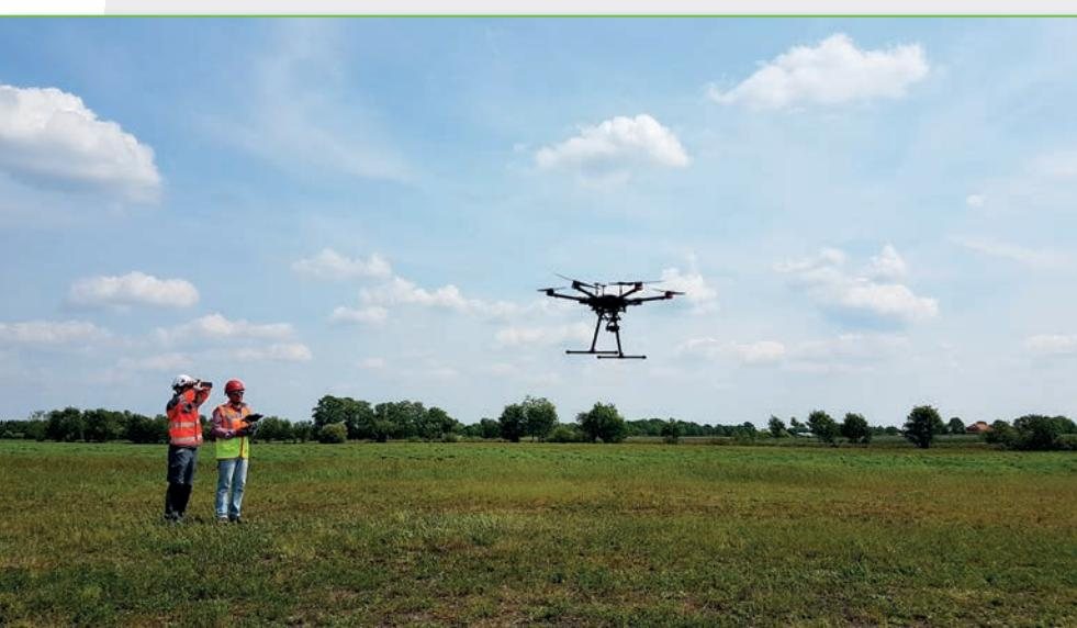
Nutzung einer Drohne zur Überprüfung des Messortes des Laserstrahls eines scannenden LiDAR.
