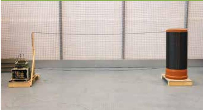
Prototyp H-Feld-Prüfstand; von links: Stromversorgung, Zuleitung, H-Feld-Spule.
