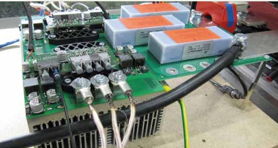
Versetzt taktender Hochsetzsteller für 130kW Leistung und 870V Ausgangsspannung.
