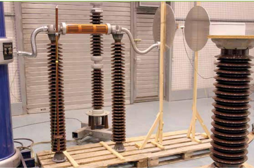
Prototyp E-Feld-Prüfstand; von links:
