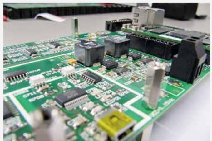
Laborprototyp einer FPGA-Ansteuerung für leistungselektronische Schaltungen.
