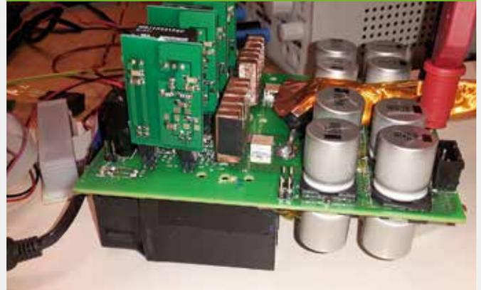
Laborprototyp mit GaN-Prototyp-Halbleitern.
