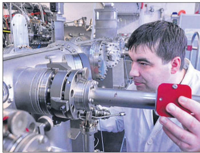
Beschichtung auf molekularer Ebene: Der wissenschaftliche Mitarbeiter Vitali Sichkovskiy kontrolliert den Vorgang, bei dem Halbleitermaterial auf Silizium übertragen wird.
