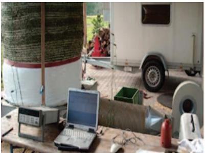
Vermessung der Luftdurchströmung von Heuballen durch das Fachgebiet Agrartechnik der Universität Kassel.
