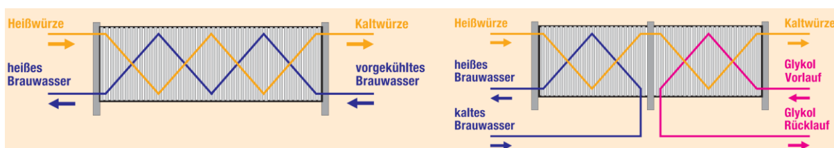
Abbildung 4-4: Schema der ein- und zweistufigen Würzekühlung (Hackensellner und Bühler, 2008)
