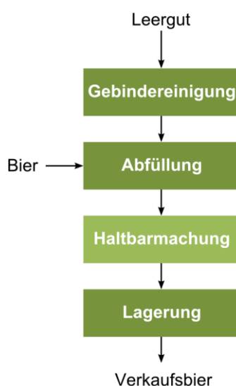
Abbildung 3-4: Produktionsablauf in der Abfüllhalle
