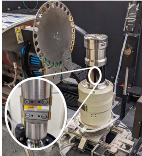
Bild 8: In Situ ( \mu -CT) Belastungseinheit DEBEN CT5000RT
