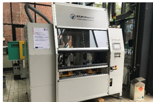
Bild 7: Schweißanlage Typ HE/SA 400 der Firma KLN Ultraschall
