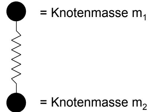
$$\begin{bmatrix} k & -k \\ -k & k \end{bmatrix} \begin{bmatrix} u \\ u_2 \end{bmatrix} - \omega^2 \begin{bmatrix} m_1 & 0 \\ 0 & m_2 \end{bmatrix} \begin{bmatrix} u \\ u_2 \end{bmatrix} = \begin{bmatrix} 0 \\ 0 \end{bmatrix}$$
