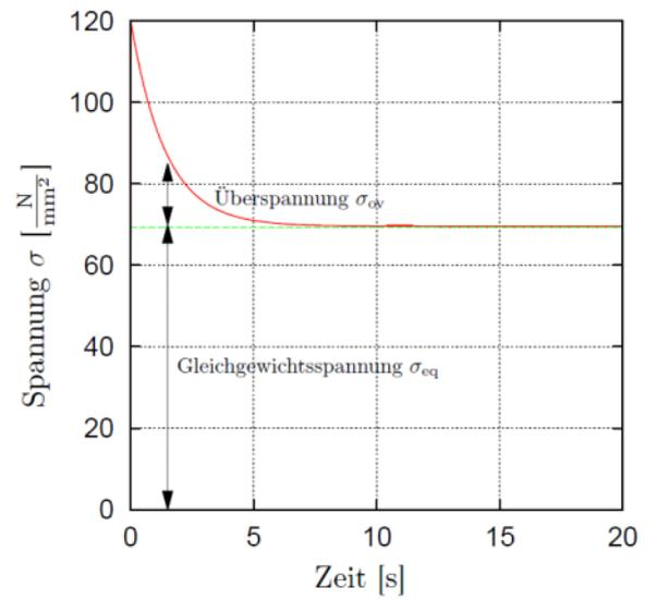
Abb. 3: Spannungsverlauf über der Zeit
