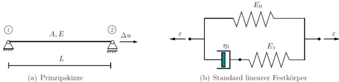
Abb. 1: Relaxationsversuch des standard linearen Festkörpers vom MAXWELL-Typ
