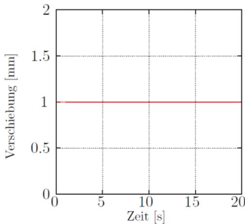
Abb. 4: Aufgebrauchte Verschiebung
