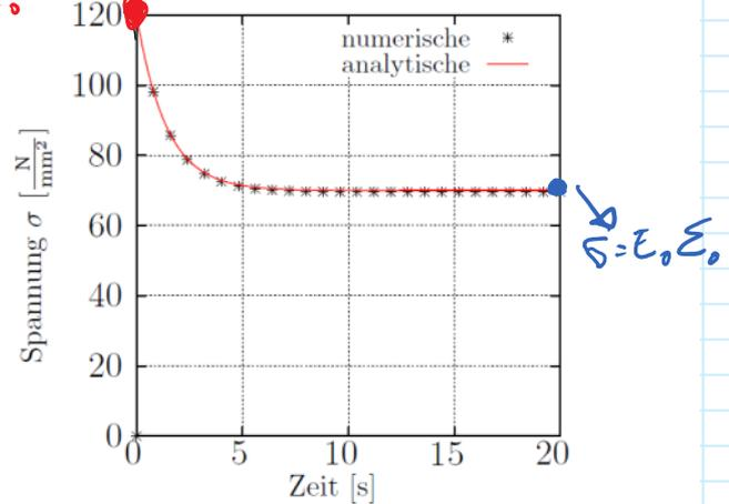
Abb. 5: Vergleich der analytischen und numerischen Lösung für die Spannungen
