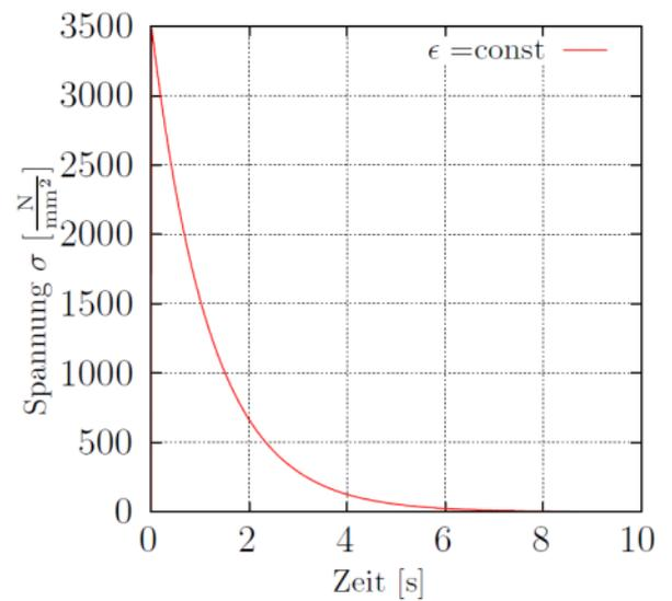
Abb. 8: Spannungsverlauf über der Zeit
