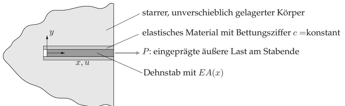
Die Differentialgleichung (DGL) für die Längsverschiebung  $u(x)$  des elastisch gebetteten Dehnstabs unter der Längsstreckenlast  $n(x)$  kann aus der lokalen Gleichgewichtsbedingung gefunden werden. Dazu wird ein Stabelement der Länge  $\Delta x$  betrachtet. Der Einfluss der nachgiebigen Klebverbindung auf den Bolzen wird durch das WINKLERSche Modell für die elastische Bettung mit Hilfe der konstitutiven Gleichung
