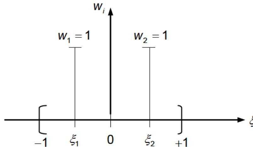
Abb. 1.5-3: Stützstellen und Wichtungsfaktoren für GAUSSsche Integration 2. Ordnung
