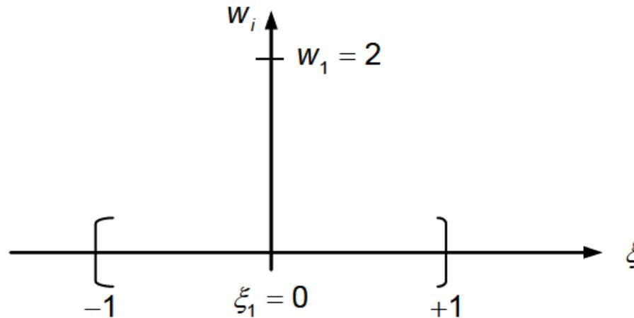
Abb. 1.5-2: Stützstelle und Wichtungsfaktor für GAUSSsche Integration 1. Ordnung
