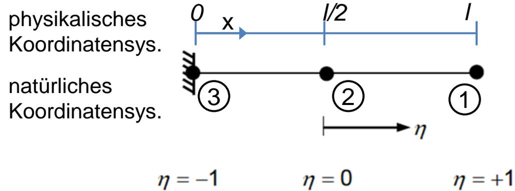
Variablentransformation:  $x \rightarrow \eta$ , d. h. Stablängskoordinate  $x$  auf das Intervall  $[-1, +1]$  abbilden.
