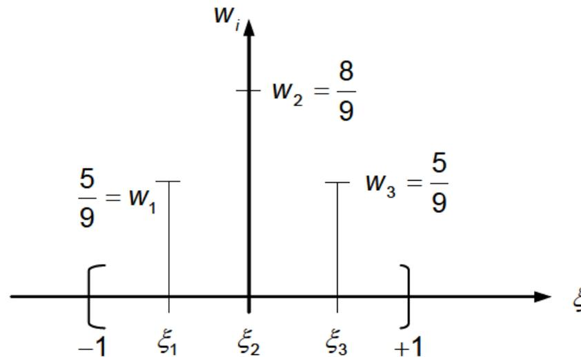
Abb. 1.5-4: Stützstellen und Wichtungsfaktoren für GAUSSsche Integration 3. Ordnung
