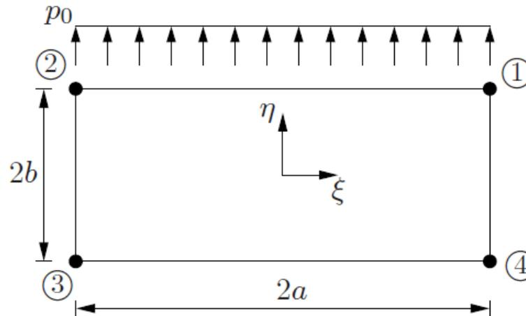
Abb. 2: Ebenes bilineares Rechteckelement unter konstanter Streckenlast
