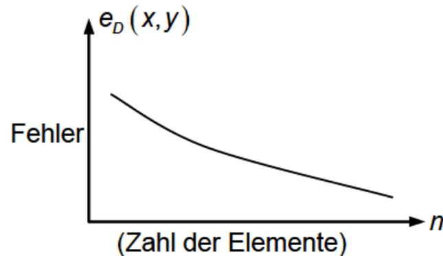
Abb. 5.8-5: Approximationsfehler in Abhängigkeit der Elementanzahl
