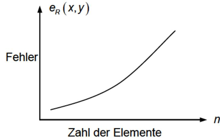
Abb. 5.8-6: Abbruchfehler in Abhängigkeit der Elementzahl
