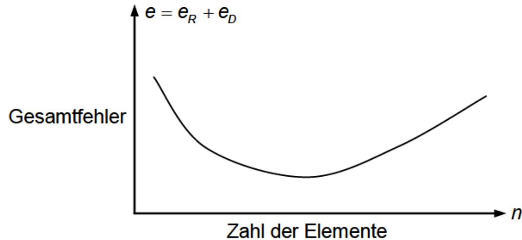
Abb. 5.8-7: Gesamtfehler in Abhängigkeit der Anzahl der Elemente
