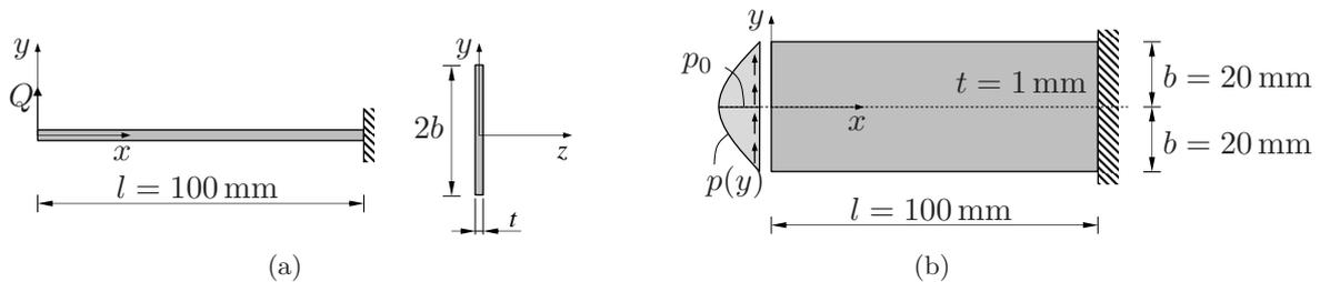
**Abb. 1:** (a) Kragbalken unter Einzellast  $Q$  (b) Kragstange unter konsistenter Streckenlast  $p(y)$
