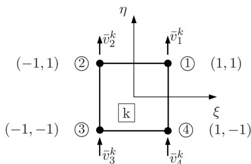
**Abb. 3:** Abb. 4: Isoparametrisches Scheibenelement
