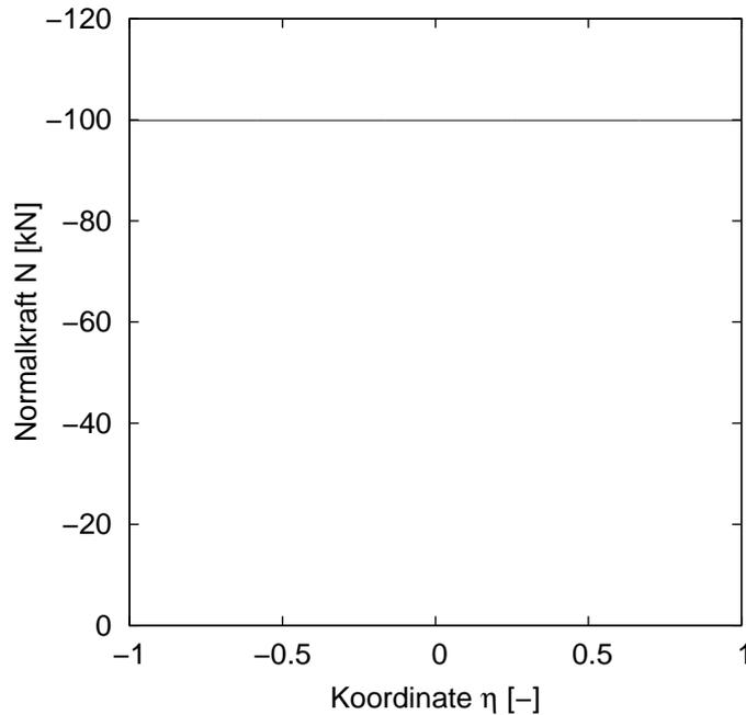
Abb. 5: Verlauf der Normalkraft im Dehnstab bei beidseitiger Lagerung
