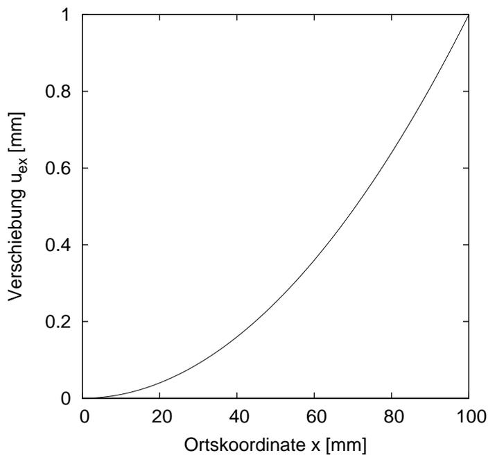
Abb. 6: Exakter Verschiebungsverlauf im Dehnstab
