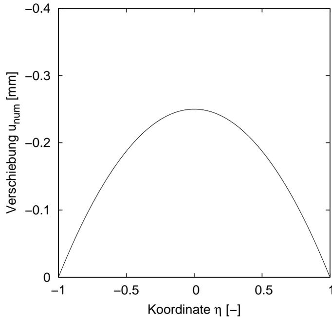
Abb. 3: Verschiebungsverlauf im Dehnstab bei beidseitiger Lagerung
