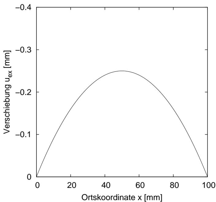
Abb. 7: Exakter Verschiebungsverlauf im Dehnstab bei beidseitiger Lagerung
