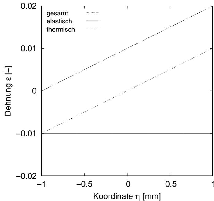
Abb. 4: Dehnungsverläufe im Dehnstab bei beidseitiger Lagerung
