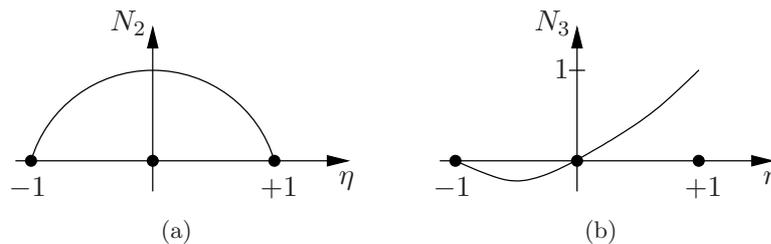
**Abb. 1:** (a) Formfunktion  $N_2(\eta)$  (b) Formfunktion  $N_3(\eta)$
