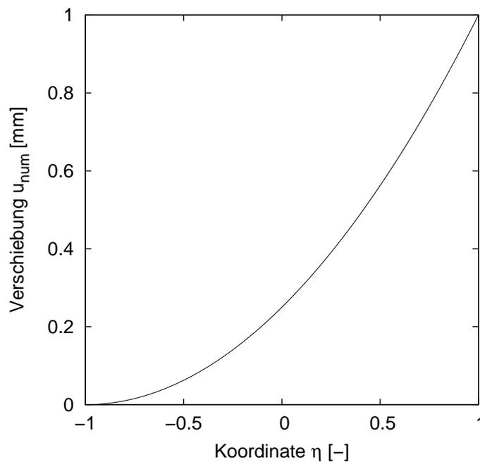
Abb. 2: Verschiebungsverlauf im Dehnstab
