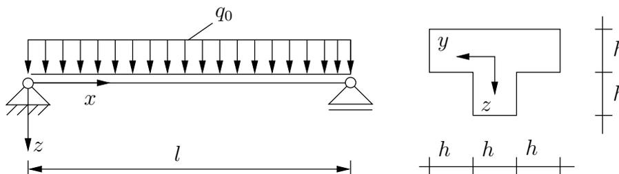
**Gegeben:**  $q_0 = 50 \frac{\text{kN}}{\text{m}}, l = 1 \text{ m}, \sigma_{xx} < \text{zul} = 200 \frac{\text{N}}{\text{mm}^2}$
