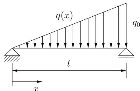
**Gegeben:**  $q_0 = 9\sqrt{3} \frac{\text{kN}}{\text{m}}$ ,  $E = 210000 \frac{\text{N}}{\text{mm}^2}$ ,  $l = 6 \text{ m}$ ,  $\sigma_{\text{zul}}^{\text{Zug}} = 160 \frac{\text{N}}{\text{mm}^2}$ ,
