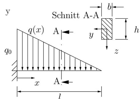
**Gegeben:**  $h = 5 \text{ cm}$ ,  $b = 4 \text{ cm}$ ,  $l = 2 \text{ m}$ ,  $q_0 = 1 \frac{\text{kN}}{\text{m}}$ ,  $E = 2.1 \cdot 10^5 \text{ MPa}$
