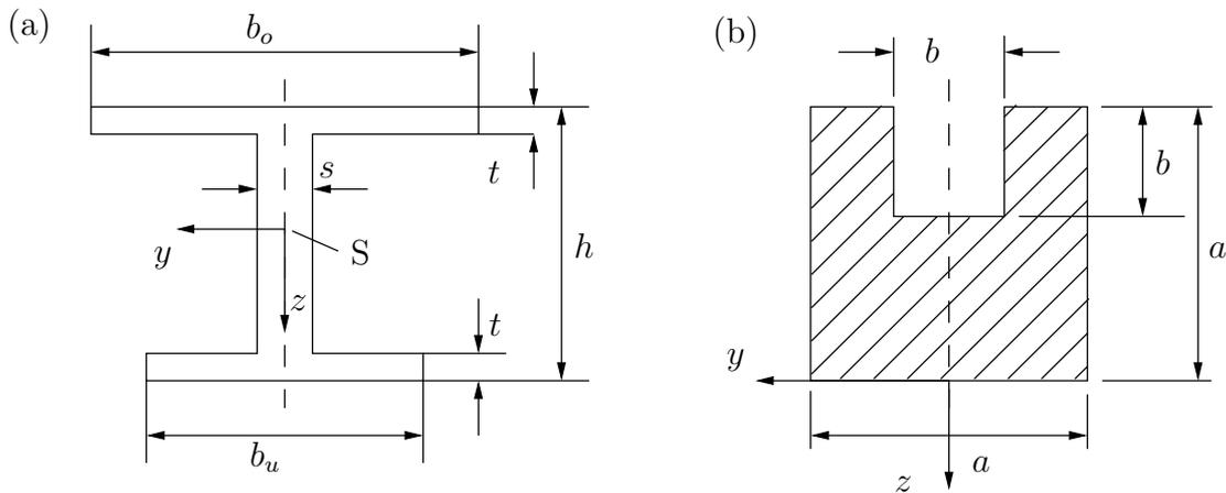
**Gegeben:** (a)  $h = 20 \text{ cm}$ ,  $b_o = 20 \text{ cm}$ ,  $b_u = 10 \text{ cm}$ ,  $s = 1.5 \text{ cm}$ ,  $t = 2.0 \text{ cm}$
