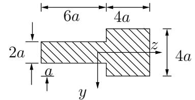
**Gegeben:**  $M_y = 12 \text{ kNm}$ ,  $N = -250 \text{ kN}$ ,  $a = 5 \text{ cm}$
