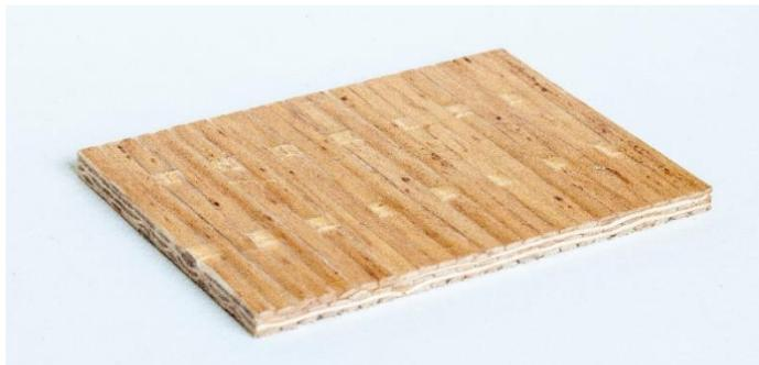
Abbildung 2: Weidengewebeverstärkter Kunststoff
