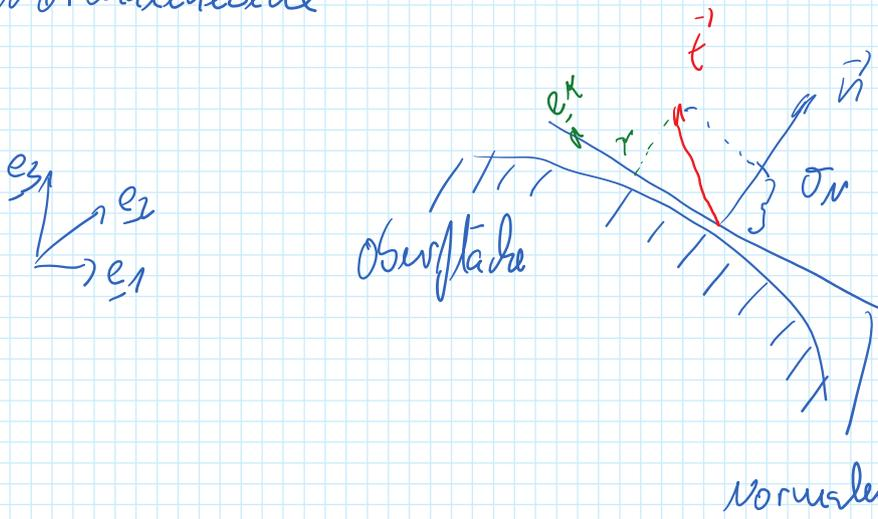
$\sigma_N$ : Spannungskomponente in Richtung des Normalen
